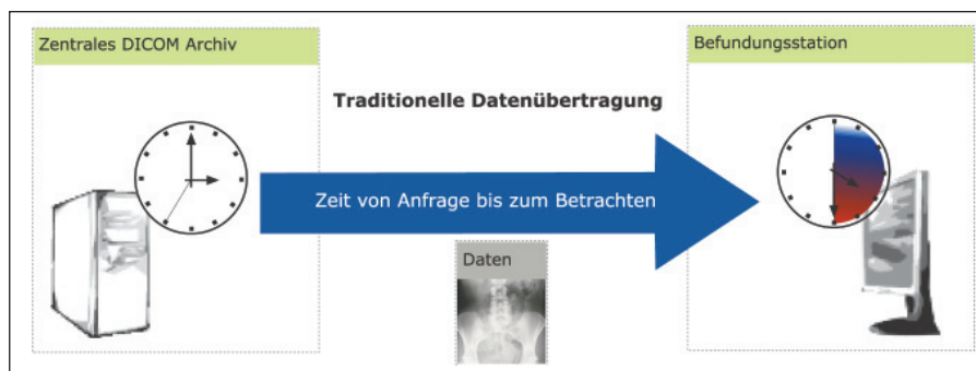
Abbildung 5: Herkömmliche, File basierte Methode der Bildübertragung. Dauer der Übertragung eines 1 MB großen Bildes über ISDN (2 Kanäle) gut 2 Minuten, 2 CT-Serien mit jeweils jeweils 30 Bildern entsprechen 30 Minuten.
