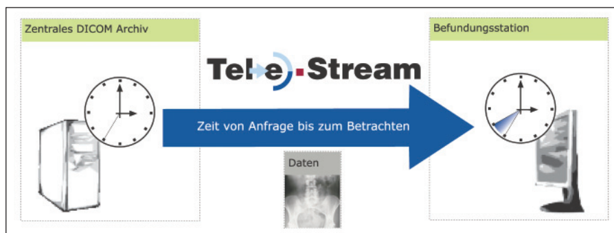
Abbildung 6: Neues Verfahren basierend auf Streaming-Technologie. Bereits wenige Sekunden nach Beginn der Übertragung werden auswertbare Bildstrukturen auf dem Desktop sichtbar. Nach Beendigung des Streaming-Vorgangs nach weiteren wenigen Sekunden ist das Bild (oder Ausschnitt) in diagnostischer Qualität sichtbar.
