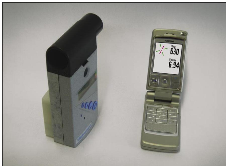
**Abbildung 3:** Am Heinz-Nixdorf-Lehrstuhl für Medizinische Elektronik entwickeltes und von der Sensor GmbH produziertes telematisches Lungenfunktionsmeßsystem
