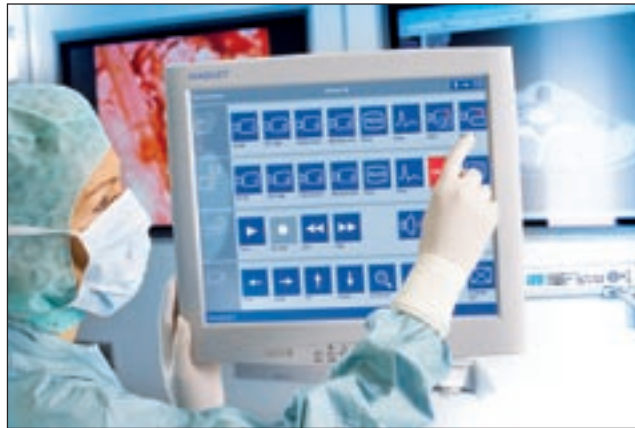
Zentraler Touchscreen: Die Auswahl der an AV CONFERENCE angeschlossenen Bild- und Datenquellen erfolgt über den Touchscreen - einfach und selbsterklärend
