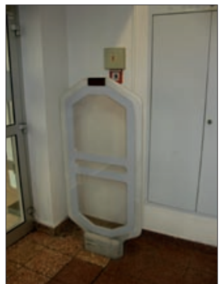
Abbildung 5: Lesegerät für 1-bit-Transponder zum Diebstahlschutz in einem Kaufhaus
